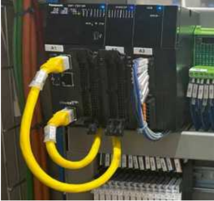
Obr. 3: Řízení polohy a pohybu zajišťuje systém GM1 od firmy Panasonic Industry
