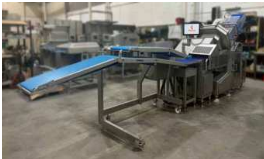
Obr. 1: Nářezový stroj Automatic SliceFil-655 od španělské firmy Finova
