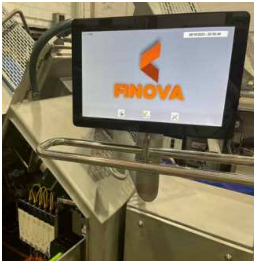
Obr. 5: Pro obsluhu stroje je určen panel HM vhodný do prostředí s velkými požadavky na hygienu
