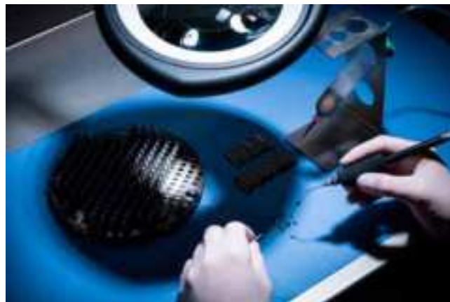
Polohování P-CBN segmentu na nosič ze slinutého karbidu
