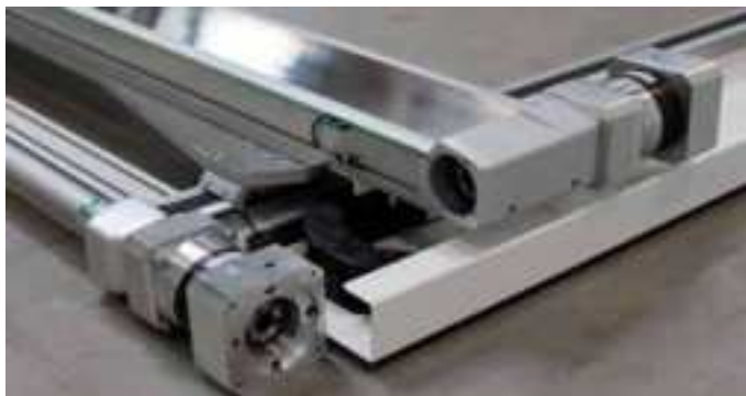
Originální dvouosý manipulátor HIWIN pro automatizovaný přesun rozložených kartonových krabic
