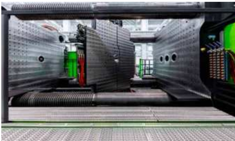
Rychlejší výměna nástrojů díky prodlouženým vzdálenostem vodicích tyčí
