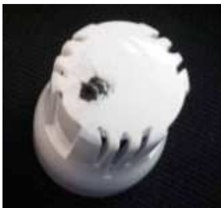
Diesel efekt – spálený plast na konci plnění
