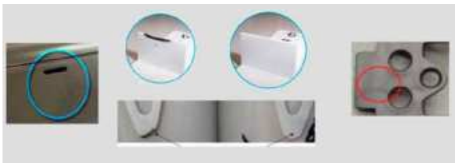
Problémy, které přináší špatné/nedostatečné odvzdušnění
