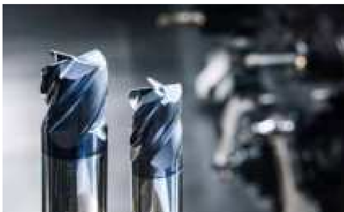
Semistandardní frézy Rotana na obrábění niklových slitin uzpůsobené zákaznické aplikaci Sanborn
