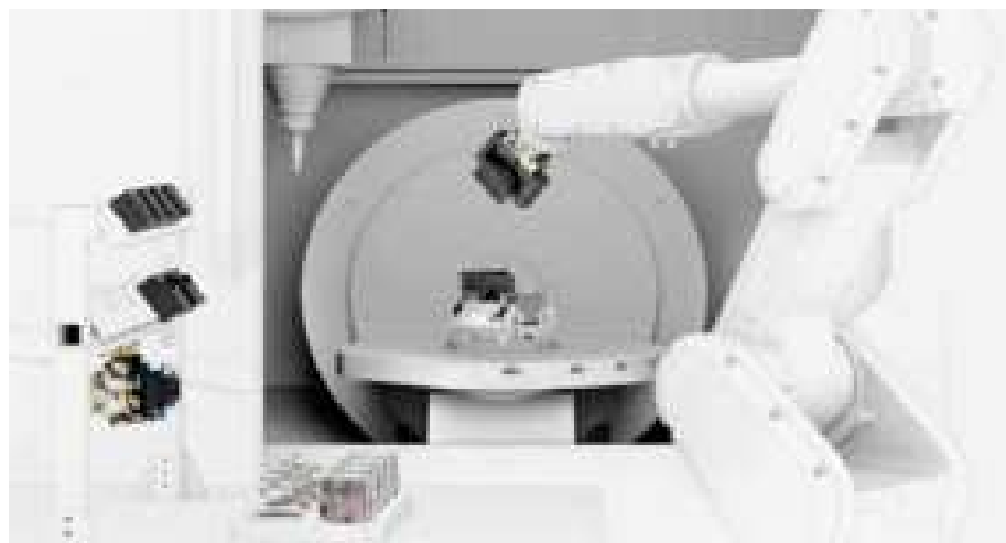
Upínací zařízení jsou vybavena rychlovýměnnými čelistmi a lze je automaticky vyměnit během několika sekund bez použití nářadí © SCHUNK
