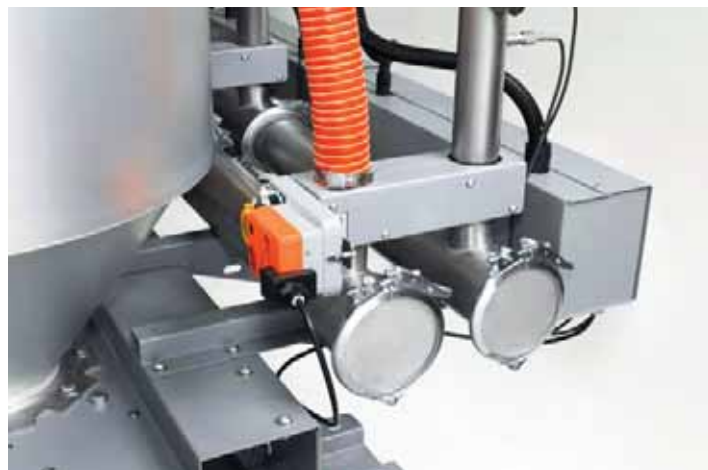
Řízení procesního vzduchu
