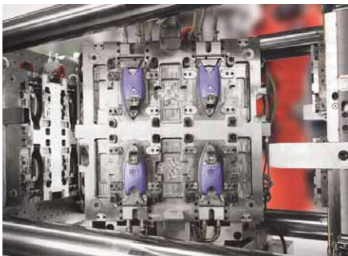
Obr. 3: Náhled do otočné formy pro 3K-vstřik: skelet žehličky je obštriknut druhým a třetím komponentem (Hofmann Innovation)
