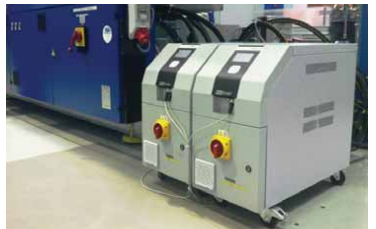
Temperovací zařízení HAHN řady ProTemp-e. Dodávají se jako jednookruhové nebo dvouokruhové temperovací přístroje i jako nadřazené nebo podřízené jednotky. Umožňují však rovněž použití v kombinaci s víceokruhovou temperovací technologií HAHN PulseTemp
