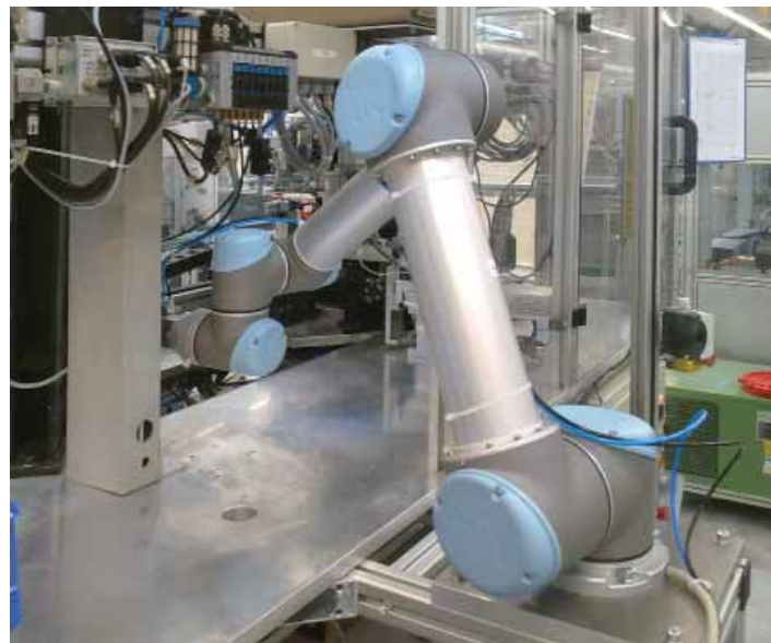
Obsluha stroje - robot UR5 pracuje bez zabezpečení
