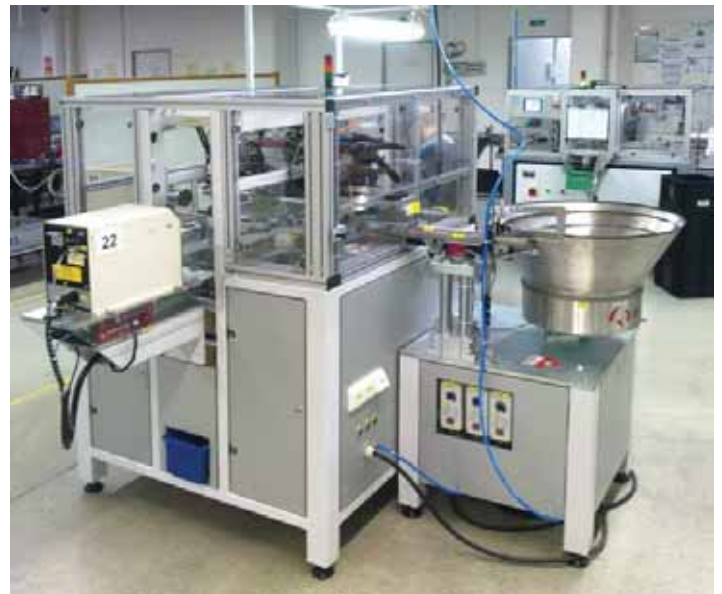
Příklad stavby Jús s použitím modulů a komponent AFAG
