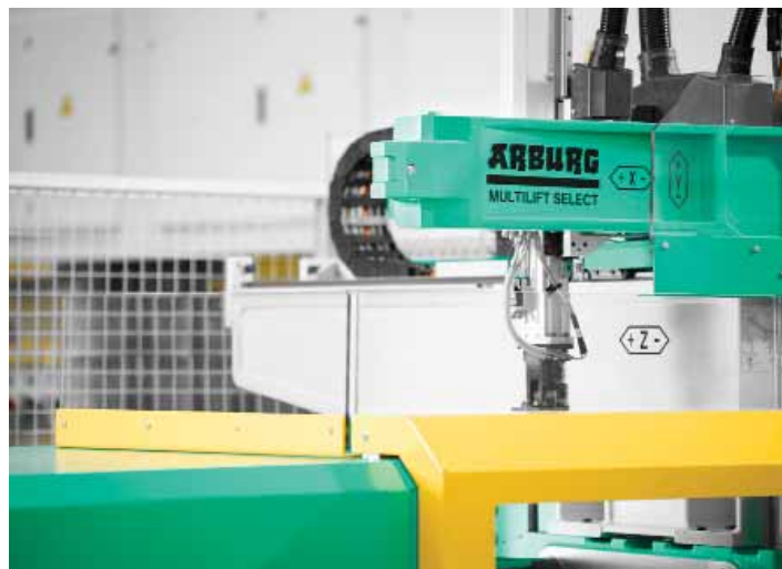
Součástí řešení automatizace je kromě vertikálního robotického systému Multilift Select, bezpečnostního hrazení s elektrickým připojením a dopravníkového pásu také CE certifikace Foto: Arburg
